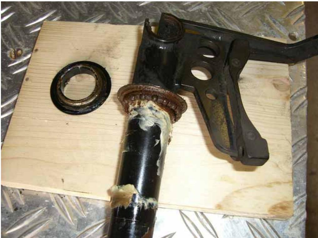
Im Dezember 2008 hatte ich alles bereits zerlegt und gereinigt. Ich denke nicht das, noch einmal Wasser eindringen konnte, da ja zusätzliche Schutzmaßnahmen von mir angebaut wurden. Die schmierige rostfarbene Fettmasse ist das Ergebnis der bereits durch Rost geschädigten und wiederverwendeten Lager.
