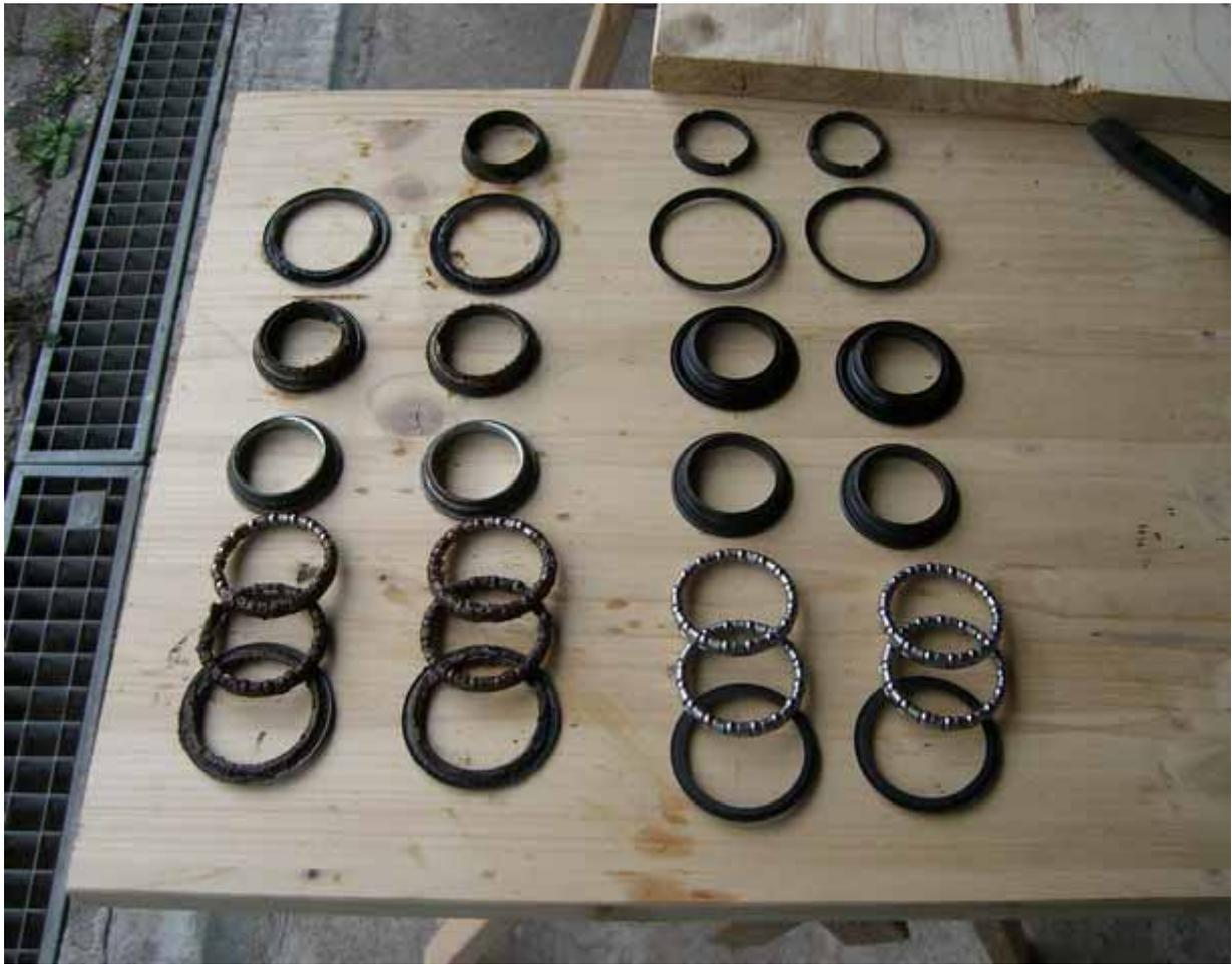
Die neuen Lagerschalen sind etwas breiter und passgenauer mit den mitgelieferten Dichtringen im Vergleich zu den alten von Ende 2007, was für eine Qualitätsverbesserung gegen Dreck Nässe seitens des Herstellers spricht. Ich werde trotzdem die von mir angefertigten Kunststoffabdeckungen weiter verwenden, da ich damit auch die Bremssättel vor Dreck und Nässe schützen kann.
